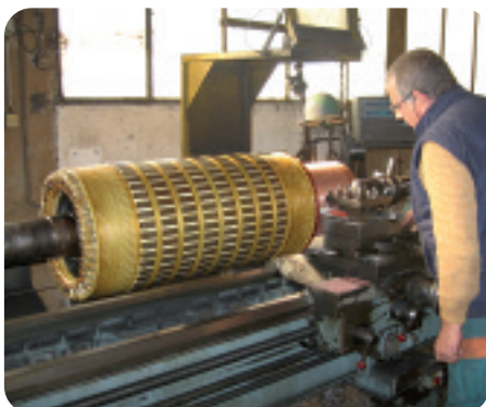
Usinage d'un collecteur
